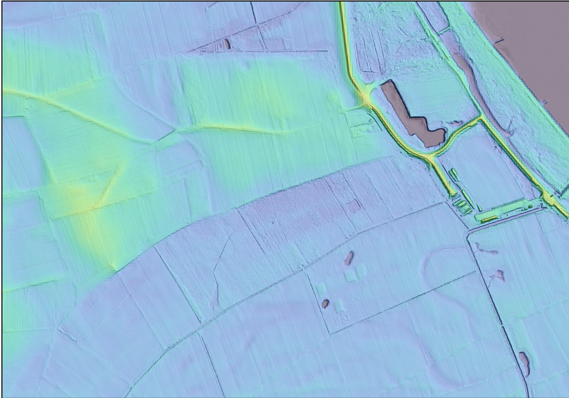
Abb. 8: Auswertung LIDAR-Scan. Im LIDAR-Scan sind sehr gut die Höhenstufen erkennbar und vor allem die markante Uferkante des Altmäänders „Bellenwiesen“. Sehr gut (in gelb) zeichnet sich auch die sinnvollste Deichtrasse auf dem nördlich angrenzenden Höhenzug ab. Auf dieser Linie wäre die geringste Deichhöhe erforderlich, um auf das Ausbaumaß von 90,12 müNN zu kommen.
