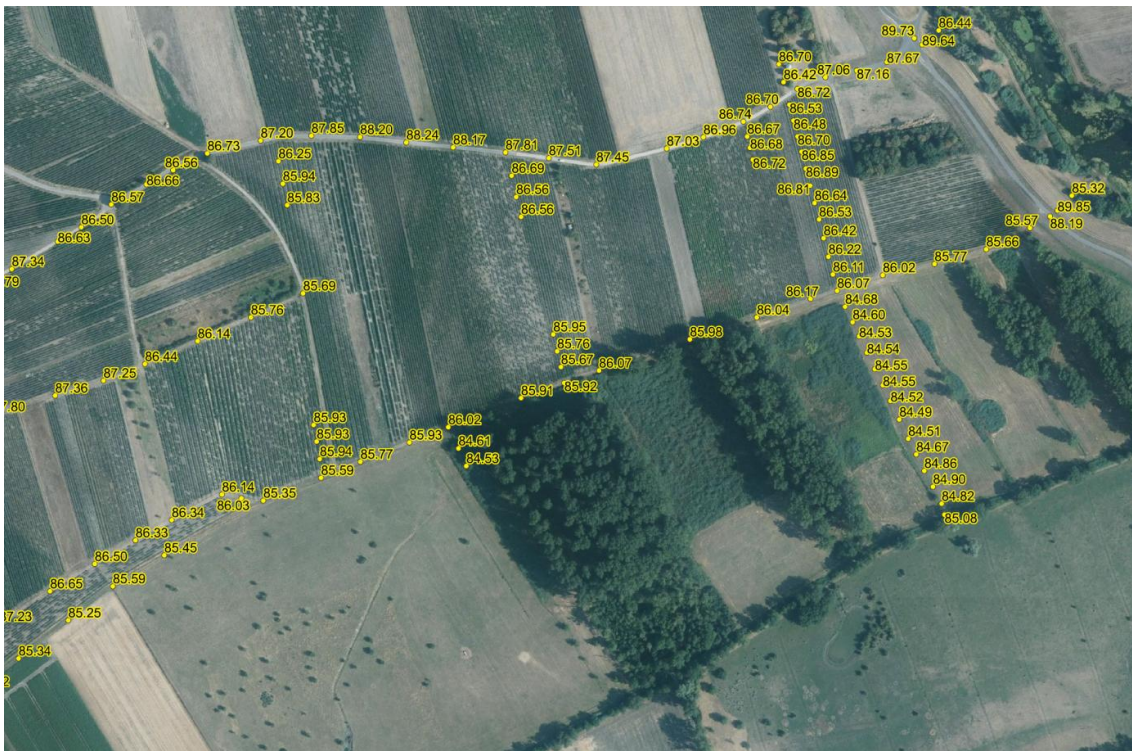
Abb. 9: Karte der Topographie. Durch die Verbände beauftragte Vermessung der Geländehöhen zur Ermittlung eines Trassenverlaufs des RRE-Deiches, welcher sowohl das Vogelschutzgebiet schützt als auch zu einer Reduzierung der Flächeninanspruchnahme für den Deichbau führt (Auflage Nr. 1 u. Nr. 12 ROV).
